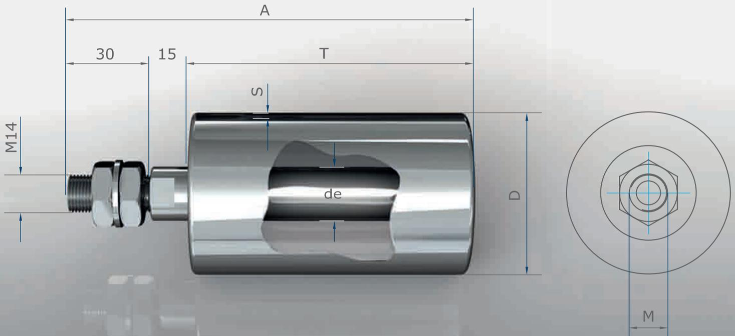
RULLI GUIDA NASTRO - BELT GUIDE ROLLERS
