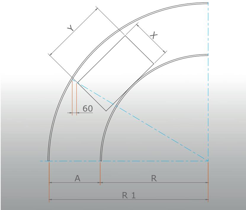
Le rulliere folli curve possono essere realizzate con rulli cilindrici doppi, assi con rotelle, rulli conici.
