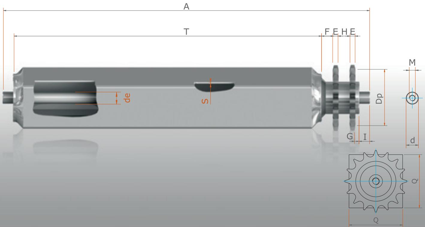
**RULLI CON PIGNONE PPAQ - PPAQ PINION SPROCKET ROLLERS**
